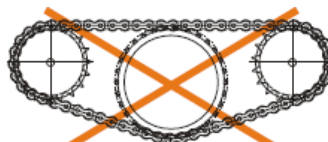
zu wenig Verformung
